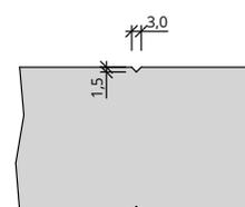
Maße gelten für gefälzte Elemente, bei stumpfen Elementen müssen seitlich und oben 13mm abgezogen werden
