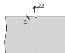
Maße gelten für gefälzte Elemente, bei stumpfen Elementen müssen seitlich und oben 13mm abgezogen werden
