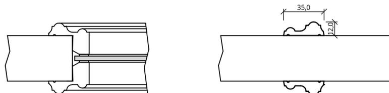
Maße gelten für gefälzte Elemente, bei stumpfen Elementen müssen seitlich und oben 13mm abgezogen werden
