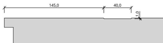
Maße gelten für gefälzte Elemente, bei stumpfen Elementen müssen seitlich und oben 13mm abgezogen werden
