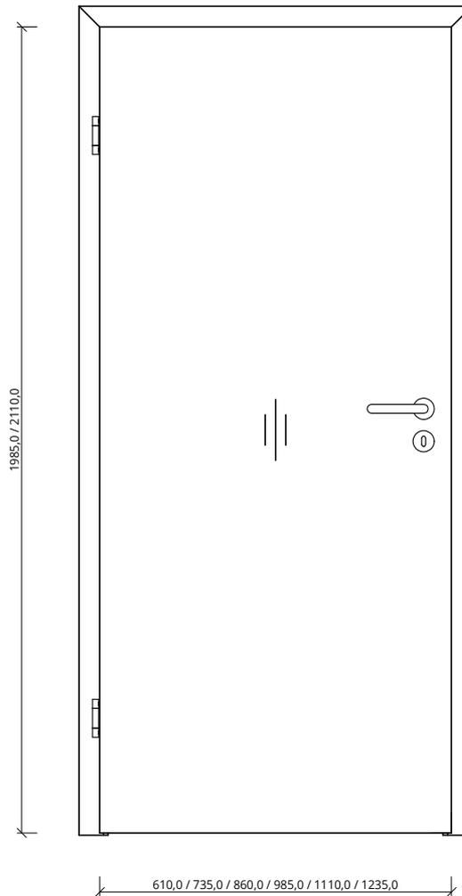
Maße gelten für gefälzte Elemente, bei stumpfen Elementen müssen seitlich und oben 13mm abgezogen werden
