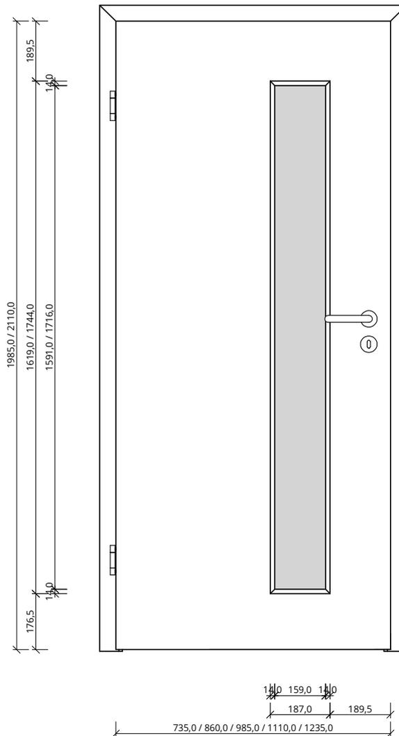
Maße gelten für gefälzte Elemente, bei stumpfen Elementen müssen seitlich und oben 13mm abgezogen werden
