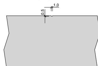
Maße gelten für gefälzte Elemente, bei stumpfen Elementen müssen seitlich und oben 13mm abgezogen werden
