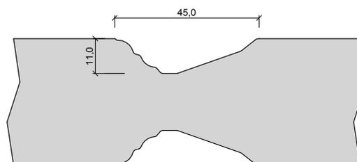
Maße gelten für gefälzte Elemente, bei stumpfen Elementen müssen seitlich und oben 13mm abgezogen werden
