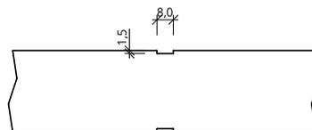
Maße gelten für gefälzte Elemente, bei stumpfen Elementen müssen seitlich und oben 13mm abgezogen werden
