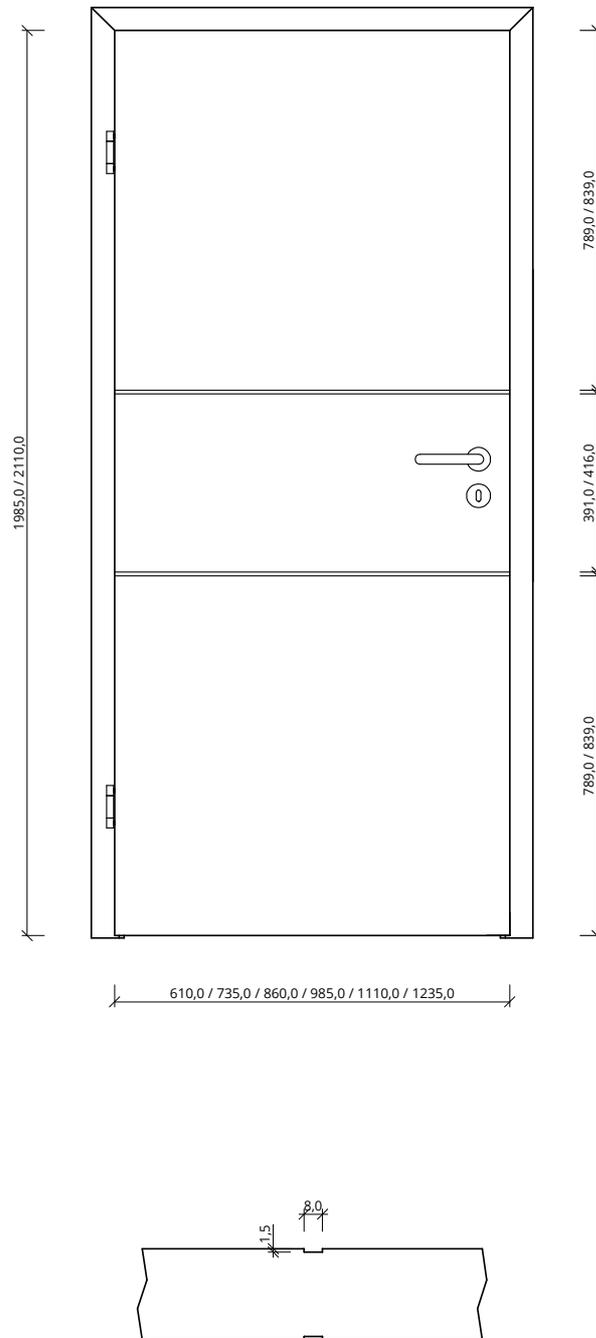
Maße gelten für gefälzte Elemente, bei stumpfen Elementen müssen seitlich und oben 13mm abgezogen werden
