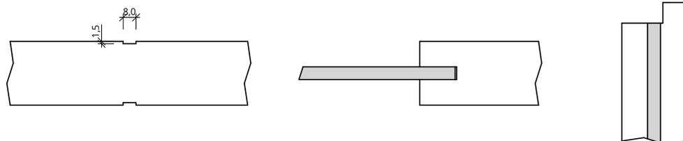
Maße gelten für gefälzte Elemente, bei stumpfen Elementen müssen seitlich und oben 13mm abgezogen werden
