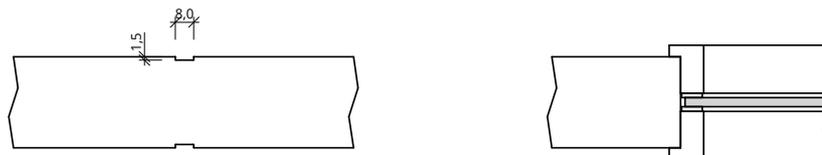
Maße gelten für gefälzte Elemente, bei stumpfen Elementen müssen seitlich und oben 13mm abgezogen werden
