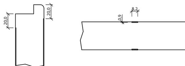
Maße gelten für gefälzte Elemente, bei stumpfen Elementen müssen seitlich und oben 13mm abgezogen werden
