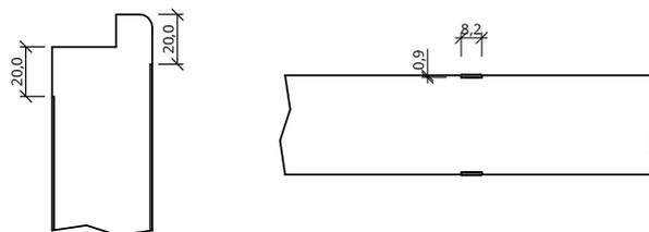
Maße gelten für gefälzte Elemente, bei stumpfen Elementen müssen seitlich und oben 13mm abgezogen werden
