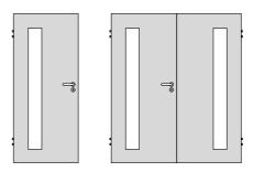
\*Bei den Glasmaßen sind umlaufend 2,5mm Luft zum Türblattausschnitt berücksichtigt!
