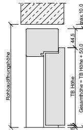
Rohbauöffnungshöhe bei GH max. 2760 mm!
