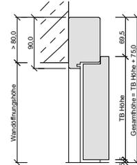
Rohbauöffnungshöhe bei GH max. 2760 mm !
