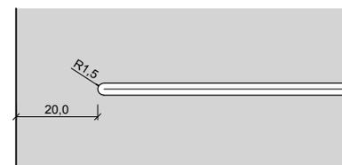
Maße gelten für gefälzte Elemente, bei stumpfen Elementen müssen seitlich und oben 13mm abgezogen werden
