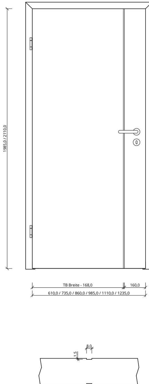
Maße gelten für gefälzte Elemente, bei stumpfen Elementen müssen seitlich und oben 13mm abgezogen werden
