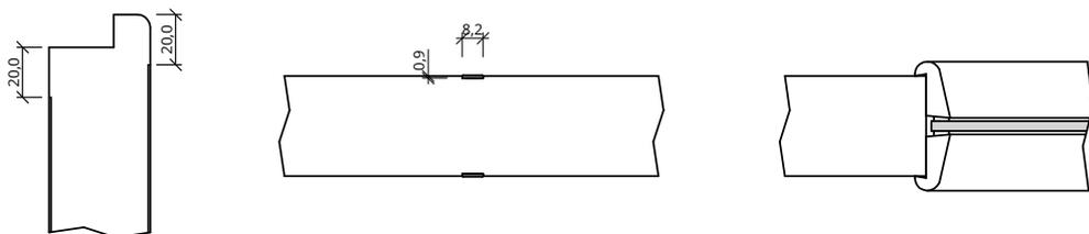
Maße gelten für gefälzte Elemente, bei stumpfen Elementen müssen seitlich und oben 13mm abgezogen werden
