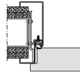
Blockzarge 2-schalig 15ZBud (Mauerwerk / Leichtbauwand)
