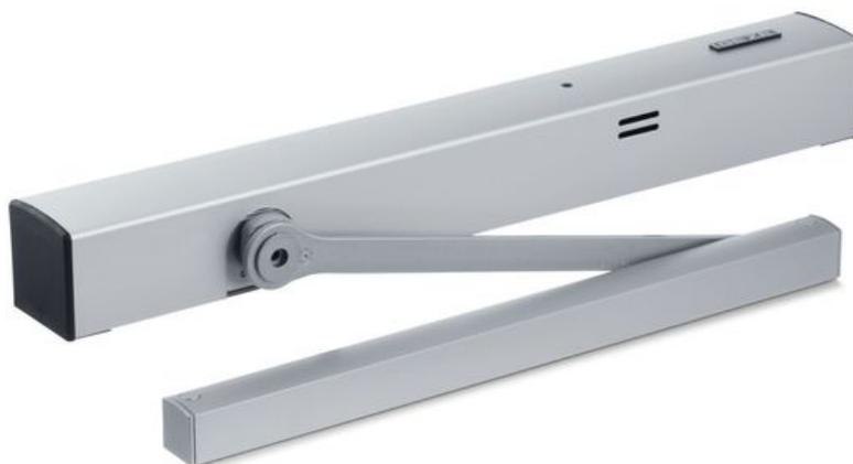
Gleitschienentürschließer für einflügelige Türen bis 1400 mm Flügelbreite mit elektrischer Freilauffunktion und Rauchschalterzentrale in Kopfmontage Bandseite
