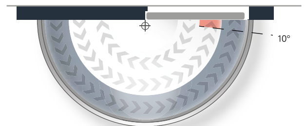
Schließkraftdiagramm ECO Newton TS-31 , Bandseite
