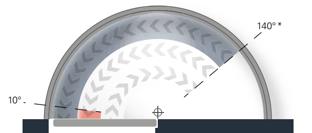
Schließkraftdiagramm ECO Newton TS-31, Bandgegenseite
