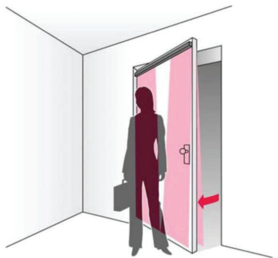
Bild 7 Infrarotvorhangsschiene zur Anwesenheitskontrolle (Quelle linkes Bild: ift Rosenheim, Quelle rechtes Bild: Firma Bircher Reglomat AG, CH-Beringen)
