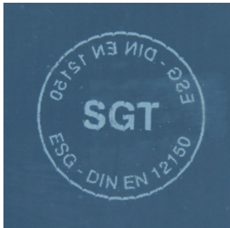
Bild 3 Muster eines Stempels für Einscheiben-Sicherheitsglas
